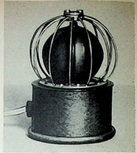
Bild 3. Betriebsmäßige Ausführung mit besonders angefertigter Papiermembran und Schutzgitter
