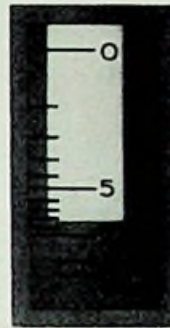
Bild 2. Das „Magische Band“ EM 840 hinter einer Blende im Gehäuse; die Leuchtfelder sind zu Markierungszwecken teilweise durch Folien abgedeckt
